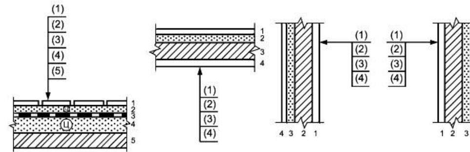
Примечание - Цифрами условно обозначена последовательность расположения слоев конструкций и надписей на полках линий-выносок.
