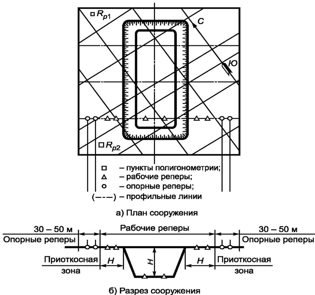
Рисунок Т.2. Схема к составлению проекта размещения реперов при открытом способе строительства подземного сооружения
